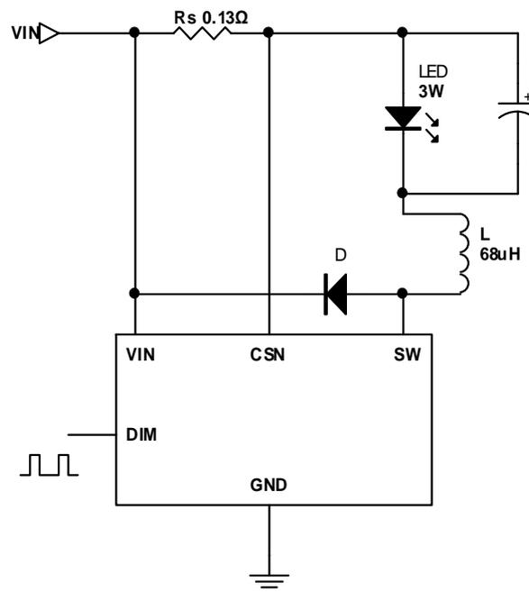
1μF的电容可以使输出纹波减少大约1/3。适当的增大输出电容可以抑制更多的纹波。需要注意的是输出电容不会影响系统的工作频率和效率，但是会影响系统启动延时以及调光频率。
