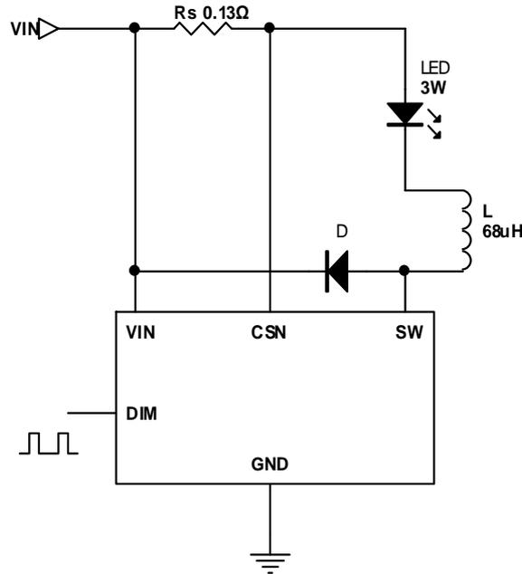
通过PWM调光，LED的输出电流可以从0%到100%变化。LED的亮度是由PWM信号的占空比决定的。例如PWM信号25%占空比，LED的平均电流为 $(0.1/R_S)$ 的25%。建议设置PWM调光频率在100Hz以上，以避免人的眼睛可以看到LED的闪烁。PWM调光比模拟调光的优势在于不改变LED的色度。DL4115调光频率最高可超过20kHz。
